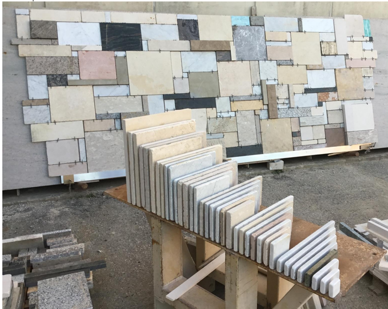
Figura 4 – I 36 formati dei moduli in primo piano ed un esempio con spessori, materiali e finiture differenti sullo sfondo
