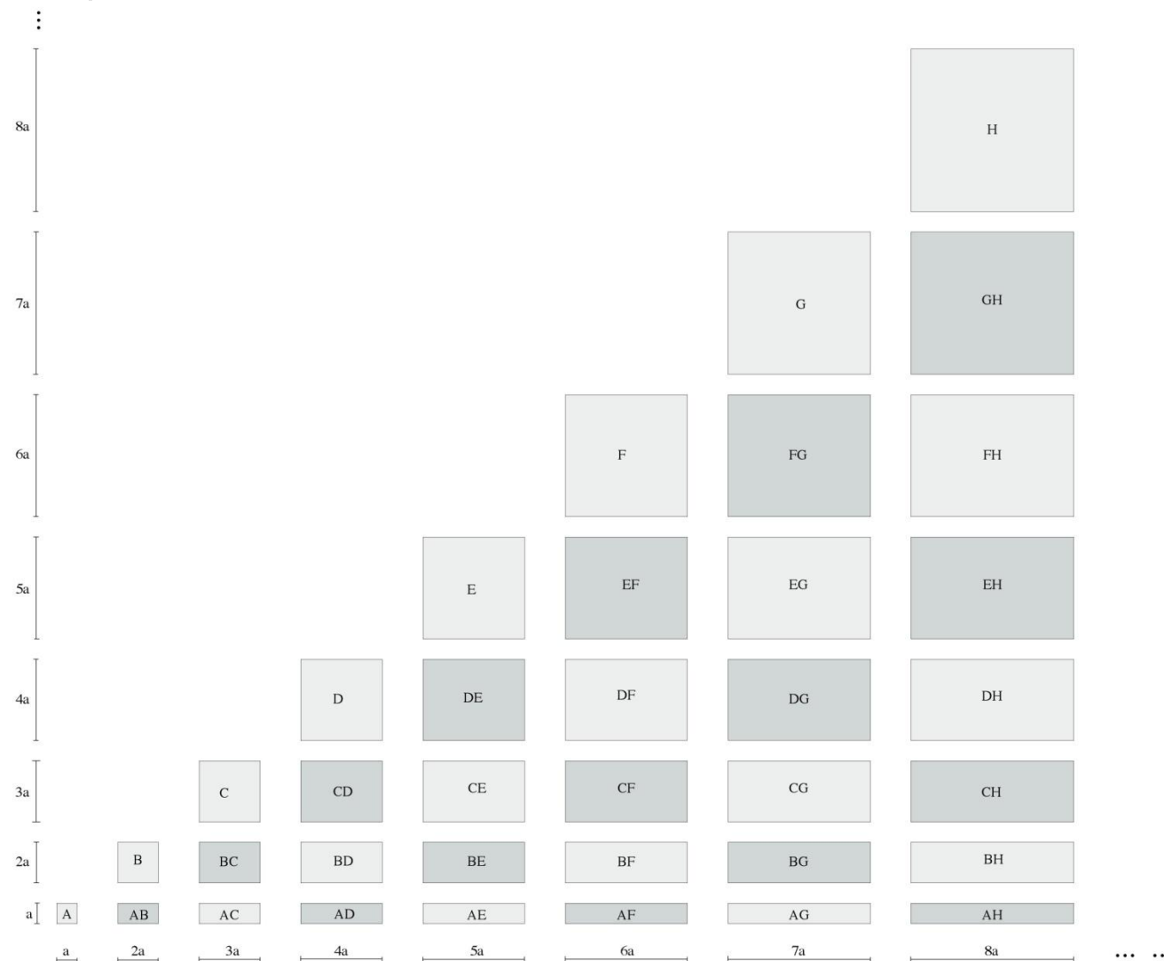
Figura 1- I moduli del sistema MUSIVE™ (patent pending) – dimensioni
